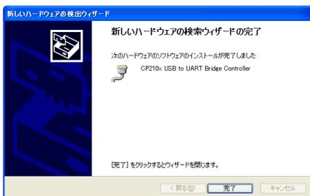
11. Windows のタスクバーの右隅にポップアップメッセージで「新しいハードウェアがインストールされ使用準備が整いました」と表示されドライバーインストールの作業は完了です。
